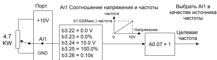
Рис. 5-7 Использование аналогового входа для задания частоты
