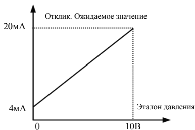
Рис.7-38 Значения эталона и ожидаемого отклика
