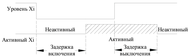
Рис. 7-13 Задержка открытия и закрытия
