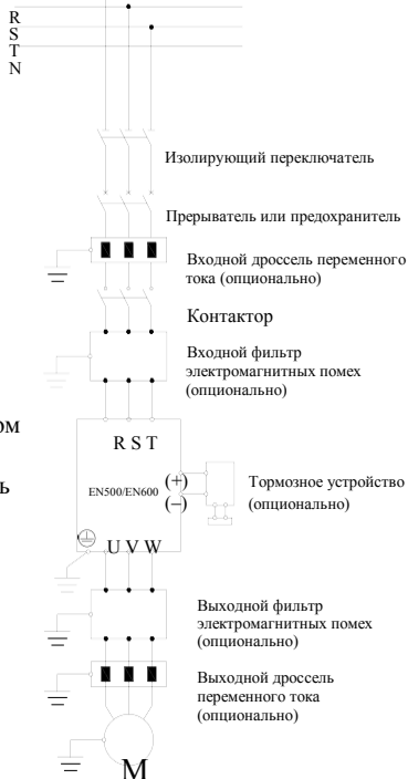
Рис.3-8 Соединение преобразователя и сопрягаемых деталей
