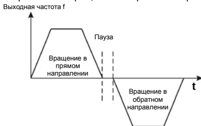
Рис. 6-4. Пауза при переходе от вращения в прямом направлении к вращению в обратном направлении
