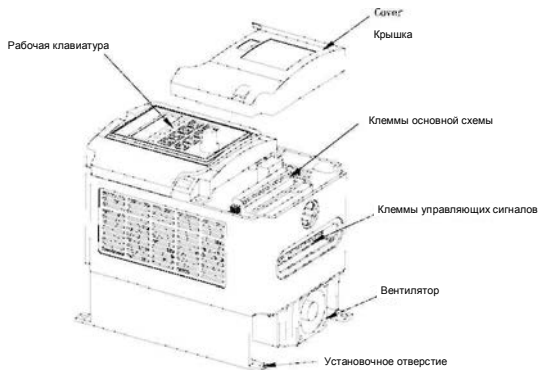
Рис. 2-1. Наименование компонентов преобразователей частоты мощностью 0,75 кВт – 18,5 кВт
