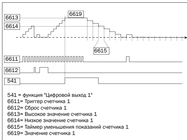
Рис. 122 Счетчики, принцип действия.
